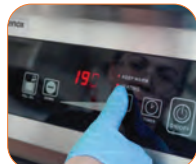
Control digital de la temperatura, con sensor digital.
