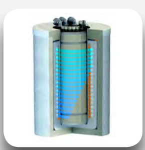
< Refrigeración "Dry Cooling".
