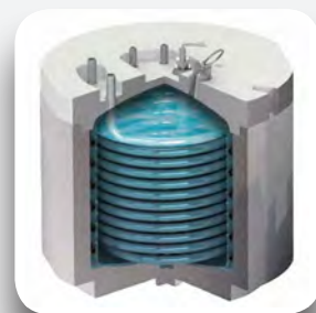
Sistema refrigeración: "BDC".
